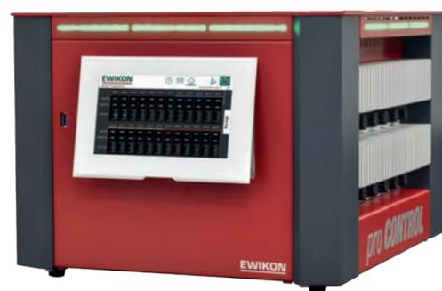
■ Pacchetto digitale completo: stampo famiglia a 16 cavità come parte calda completa, con unità monitoraggio di processo smart CONTROL e sistema di regolazione temperatura canale caldo pro CONTROL
