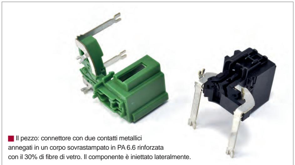
■ Il pezzo: connettore con due contatti metallici annessi in un corpo sovrastampato in PA 6.6 rinforzata con il 30% di fibre di vetro. Il componente è iniettato lateralmente.
