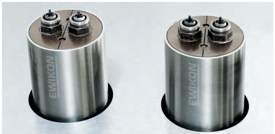
■ **Verschleißarmer Betrieb:** Ein spezieller vertikaler Dehnungsspalt im Druckkörper der HPS III-MV Mehrfach-Nadelverschlussdüse kompensiert die Wärmedehnung. Die Druckbelastung der anschnittnahen Dichtflächen und der Nadeln bleibt unkritisch.
