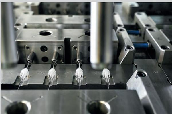
Artikel „Belüftungsadapter“ in der auswerferseitigen Formplatte mit Schiebermechanik (oben). Nadelverschluss-Heißkanalsystem für das Belüftungsadapterwerkzeug. Die Nadeln werden gemeinsam über eine Hubplatte mit pneumatischen Kolbenantrieben betätigt (rechts).
