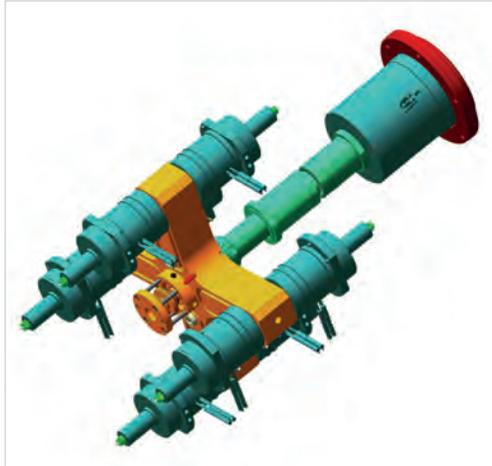
Nadelverschluss mit im Düsengehäuse integrierter Antriebseinheit in einer Etagenform
