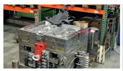
Heißkanalseite eines 2-fach Werkzeugs zur Fertigung einer kompletten Türverkleidung (oben). Die filigranen Auswerferpakete können bis zu 100 Stifte beinhalten und befinden sich in der Heißkanalseite. Gut zu erkennen: Die Aussparungen für die Düsen (rechts).
