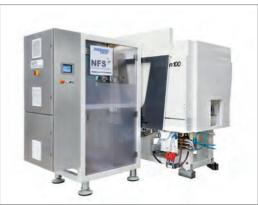
Der Antrieb der Nadeln erfolgt synchron über ein Hubplattensystem (links). Automatisierte Fertigungszelle mit Zahoransky NFS-Einheit (Needle-Feeding System) und vollelektrischer Engel e-motion Spritzgießmaschine (rechts).
