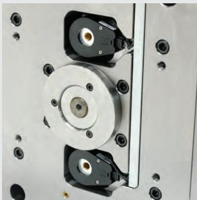
▲ Die untere Abdeckung wird mit Nadelverschluss angespritzt. Zum Einsatz kommen elektrische Schrittmotorantriebe mit Encodern zur Nadelpositionsüberwachung.
