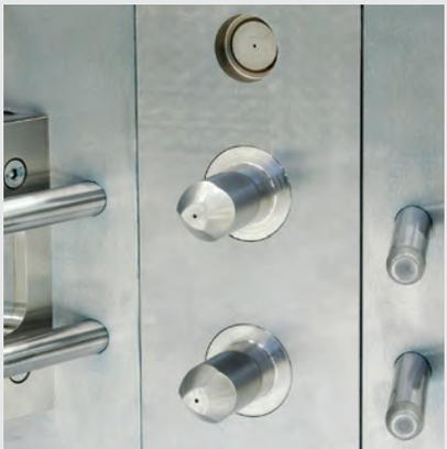
▲ Die Werkzeugeinsätze für den oberen Behälter besitzen eine konturnahe Kühlung und wurden mit dem LaserCUSING® Verfahren gefertigt.
