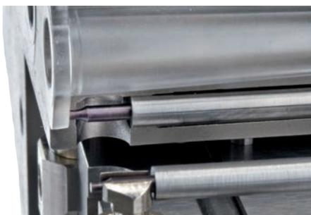
Die kombinierten Nadelführungen/-dichtungen **5** sind im ungeteilten, temperierten Formeinsatz montiert und garantieren eine hohe Dichtigkeit des Systems. Um eine gleichmäßige Wärmeverteilung im Anschnittbereich sicherzustellen, werden die Nadeln vor dem Anschnitt berührungsfrei von speziellen Wärmeleitelementen **6** umschlossen. Die Nadelführung erfolgt bis kurz vor den Anschnitt. Die freie Nadellänge beträgt nur 5 mm.
