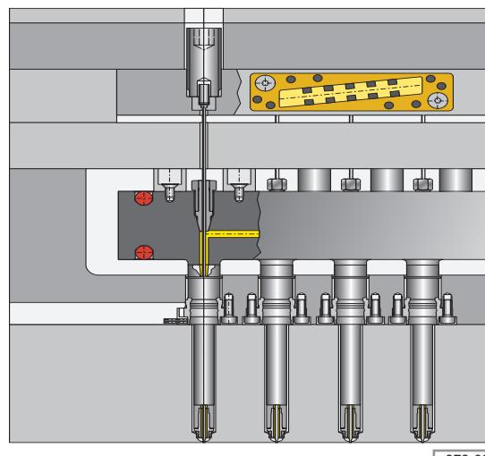
Hubplatte mit Schräglächenmechanik, pneumatische, hydraulische oder elektrische Betätigung
