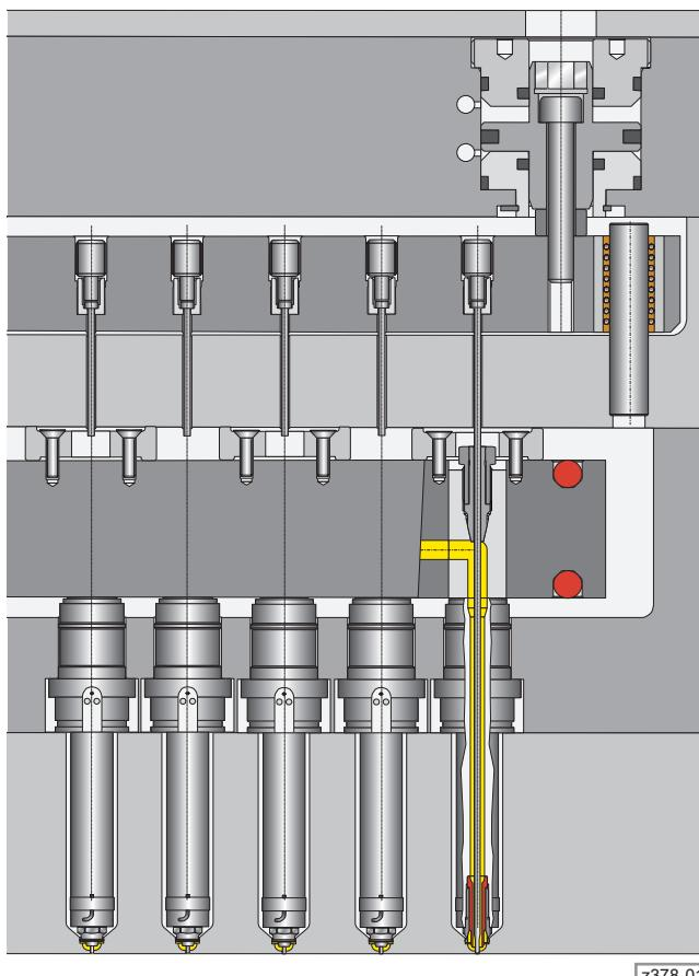
Hubplatte mit Antriebseinheit in der Aufspannplatte integriert, pneumatische oder hydraulische Betätigung
