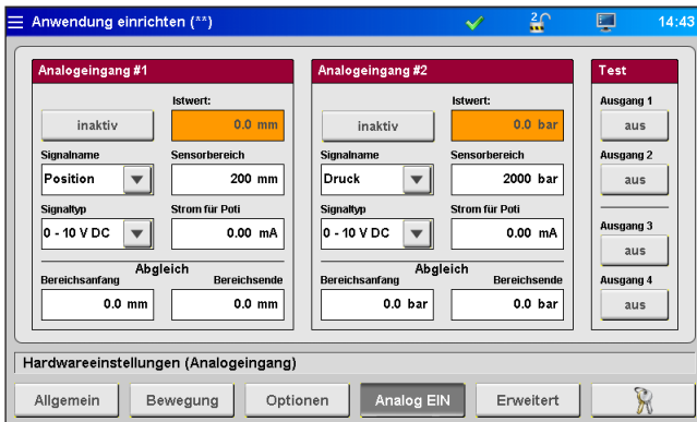
Abbildung 20: Ansicht "Hardwareeinstellungen (Analogeingang)"
