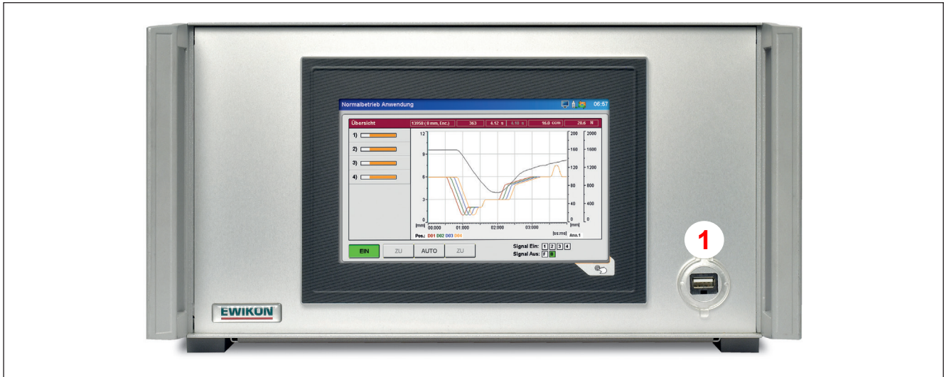
Abbildung 4: Anschlüsse an der Frontseite des EDC-PRO Steuergeräts (hier: 4-fach Gerät)
