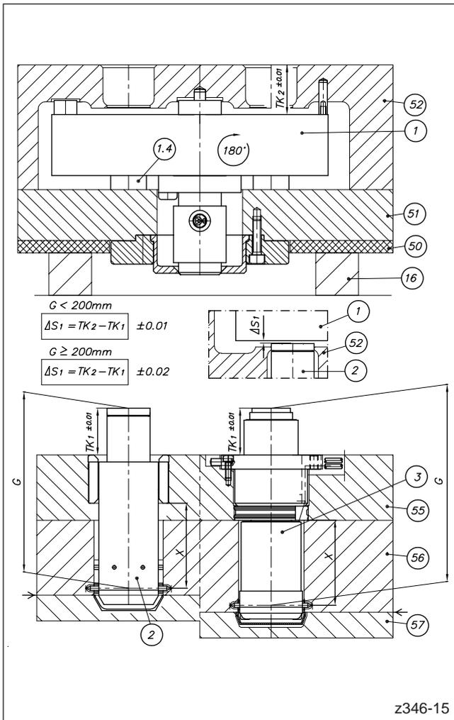
Abbildung 40: Kontrolle des Spaltmaßes  $\Delta S_1$
