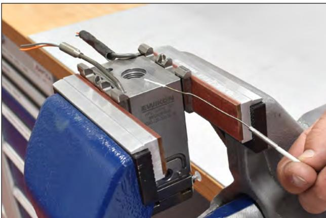
Abbildung 98: Benetzte Fühlerspitze
