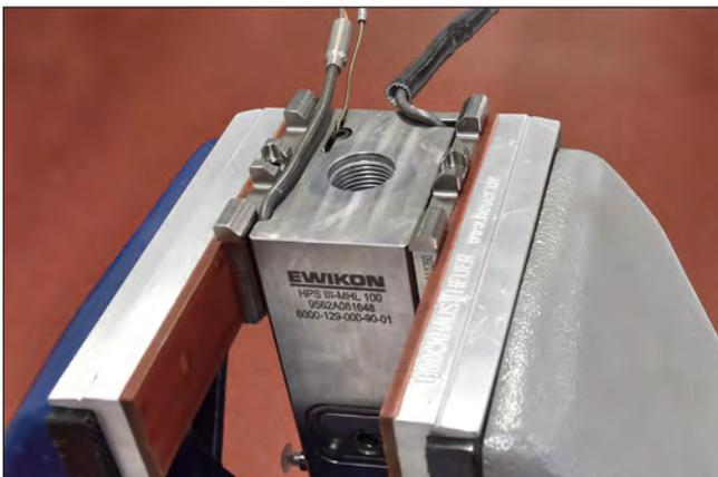
Abbildung 99: Thermofühler in die Bohrung stecken und fixieren
