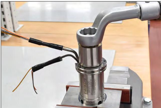
Abbildung 108: Düse einspannen, Adapter demontieren
