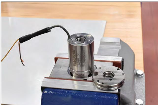
Abbildung 109: Haltering demontieren
