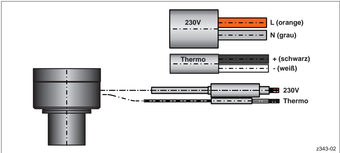
Abbildung 73: Kabelbelegung für HPS III-S Düsen (ein Regelkreis)
