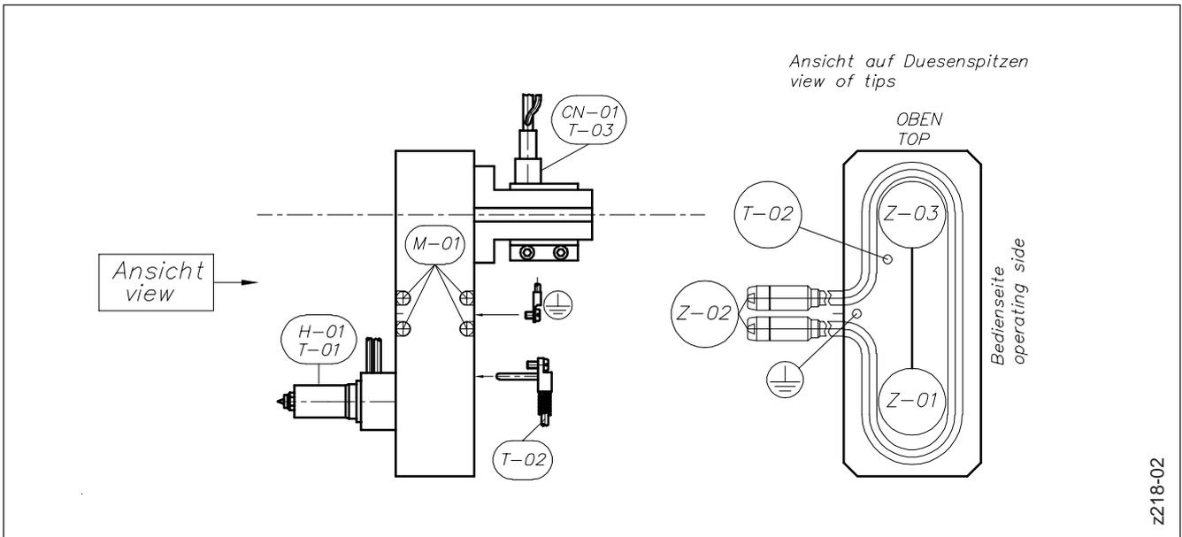
Abbildung 78: Verdrahtung von Standard-1-fach Heißkanalsystemen
