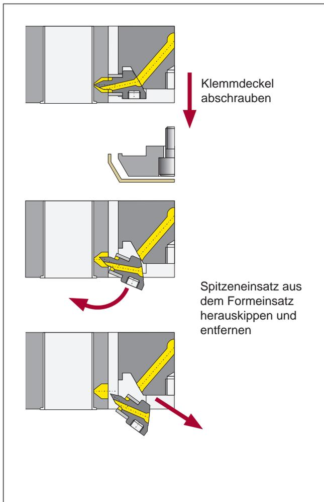
Abbildung 86: Spitzeneinsätze demontieren
