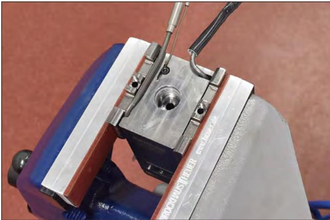
Abbildung 96: Düse einspannen, Schraube lösen
