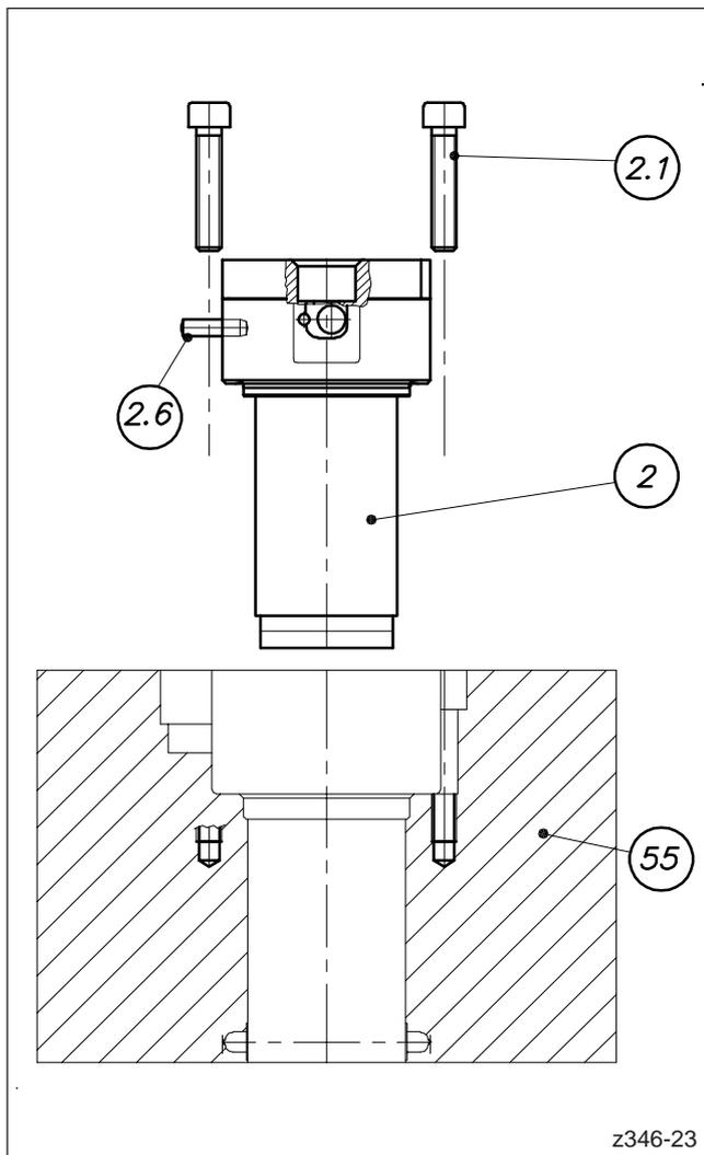
Abbildung 48: Montage des Düsenkörpers
