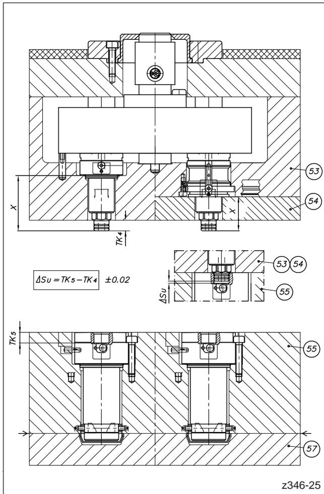
Abbildung 50: Kontrolle des Spaltmaßes  $\Delta S_u$
