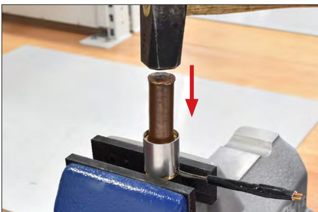
Abbildung 91: Schutzrohr demontieren
