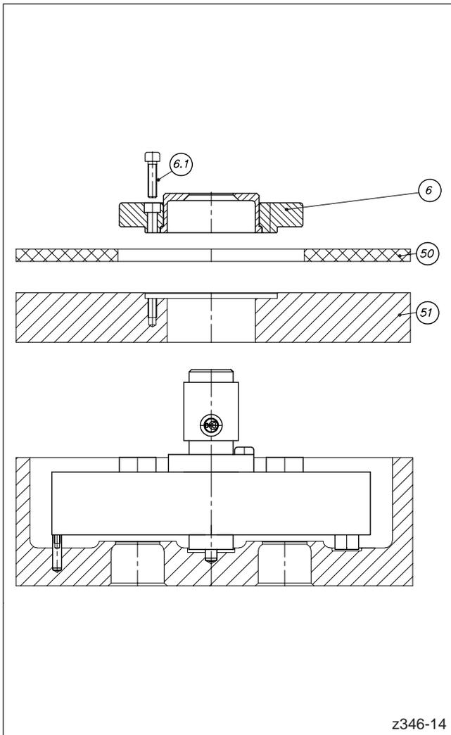
Abbildung 39: Montage der Aufspannplatte und des Zentrierrings
