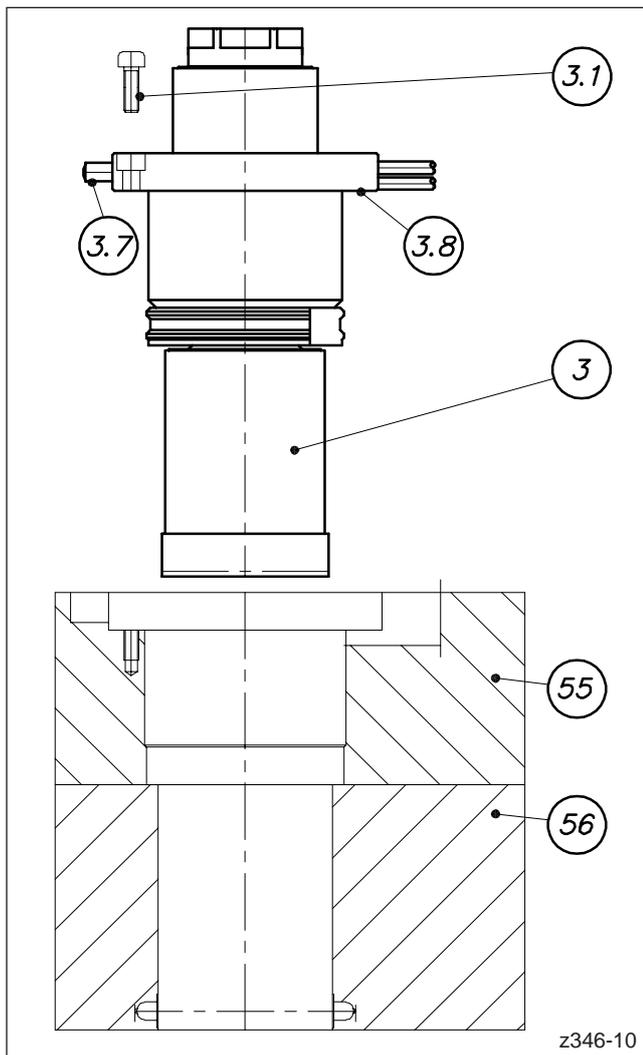
Abbildung 34: Montage des Düsenkörpers
