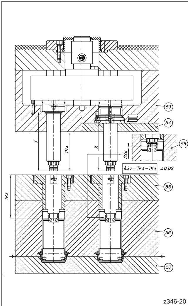
Abbildung 45: Kontrolle des Spaltmaßes  $\Delta S_u$
