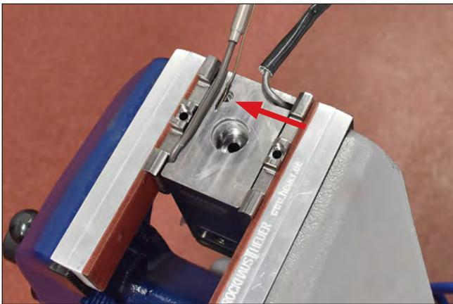
Abbildung 97: Zylinderschraube herausgedreht
