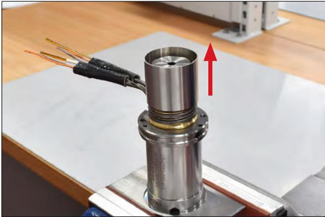
Abbildung 104: Schutzrohr abziehen
