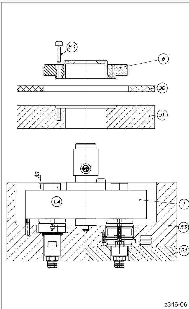
Abbildung 30: Überprüfung des Spaltmaßes  $\Delta S$  und anschließende Montageschritte
