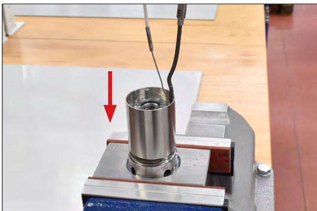
Abbildung 112: Thermofühler verlegen, Schutzrohr nachschieben
