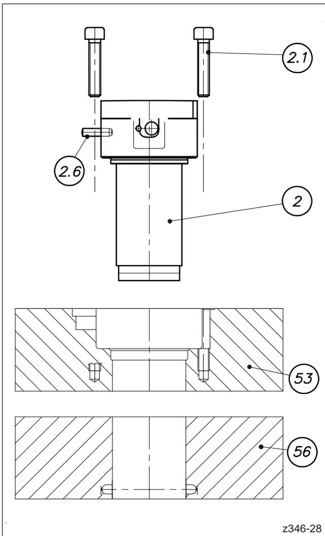
Abbildung 53: Montage des Düsenkörpers
