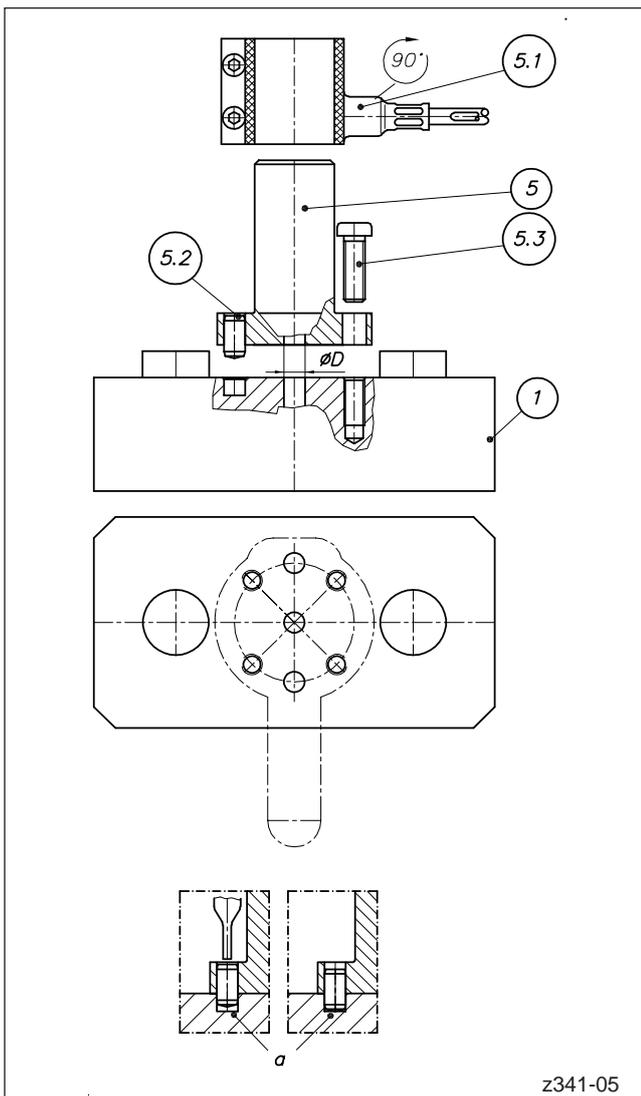
Abbildung 27: Einbau einer Angießbuchse
