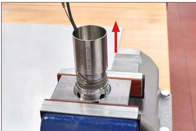
Abbildung 110: Schutzrohr abziehen
