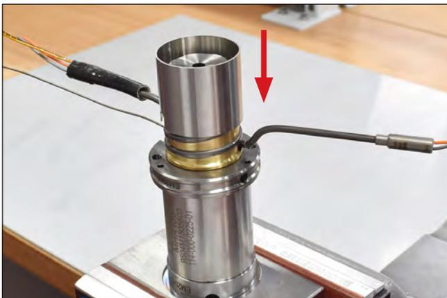
Abbildung 106: Thermofühler biegen, Schutzrohr nachschieben
