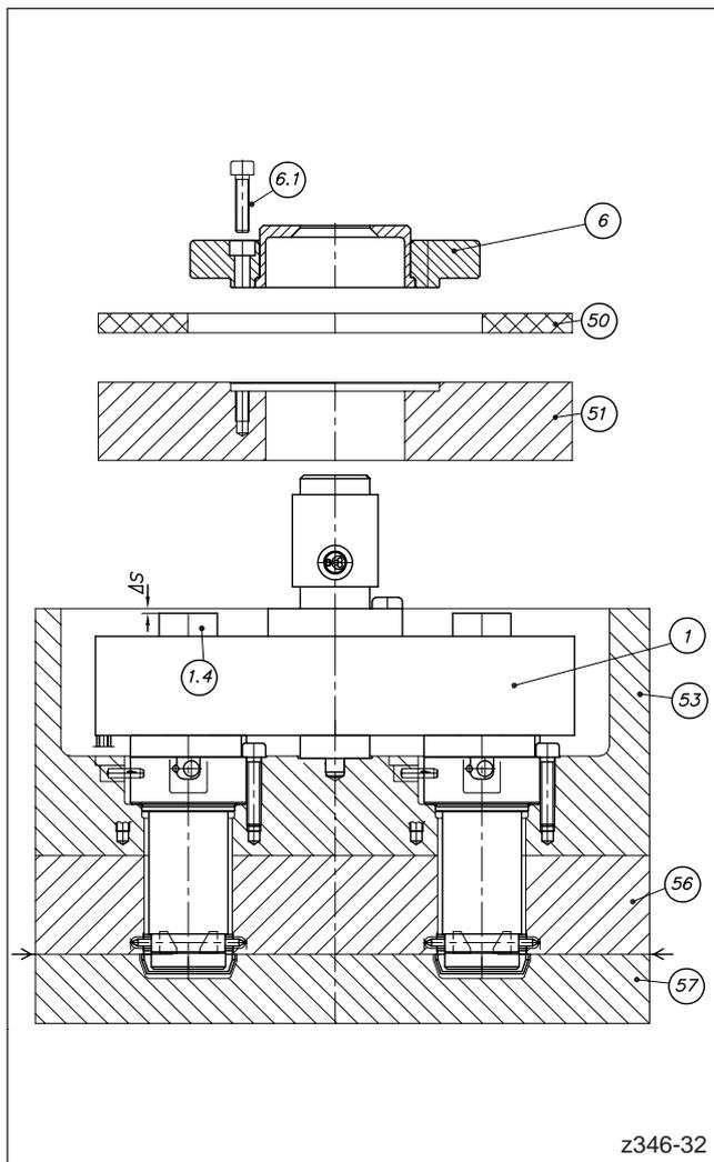
Abbildung 59: Überprüfung des Spaltmaßes  $\Delta S$  und anschließende Montageschritte
