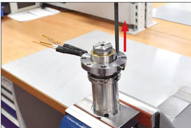
Abbildung 103: Niederhalter demontieren
