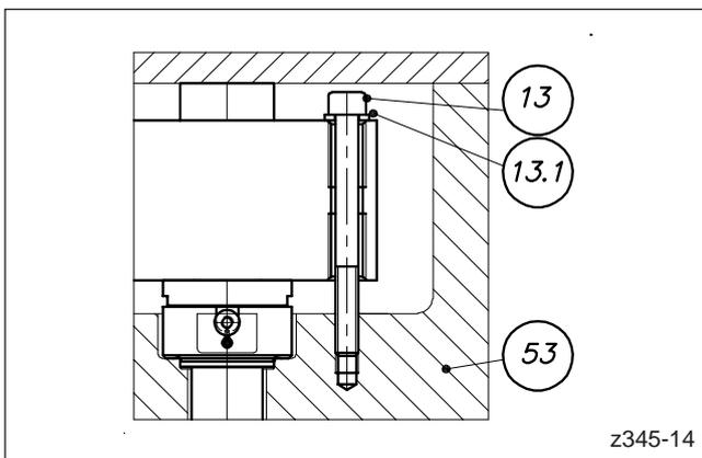
Abbildung 66: Verteilerverschraubung mit Zylinderschrauben (Nur für Standardmontage!)
