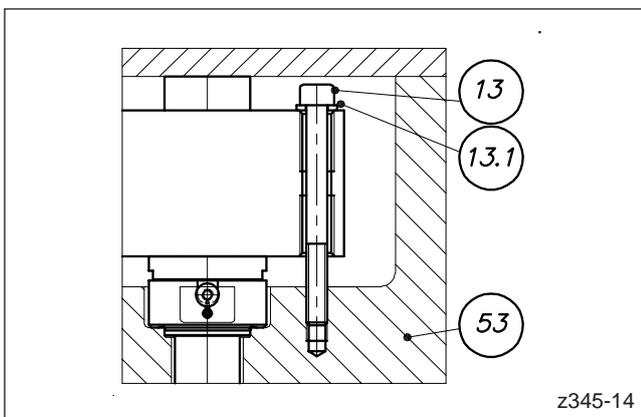
Abbildung 29: Verteilerverschraubung mit Zylinderschrauben (Nur für Standardmontage!)
