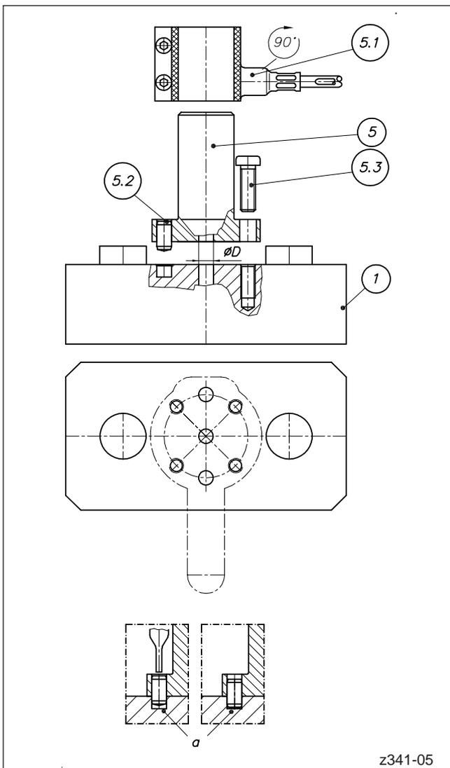
Abbildung 64: Einbau einer Angießbuchse
