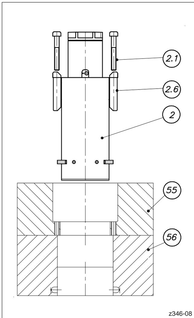
Abbildung 32: Montage des Düsenkörpers
