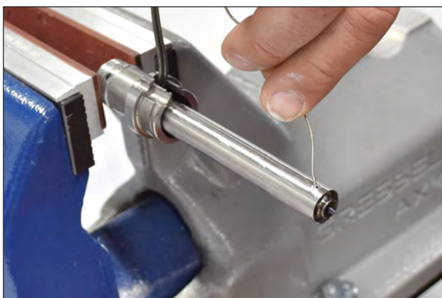
Abbildung 101: Thermofühler in die Bohrung der Düse stecken
