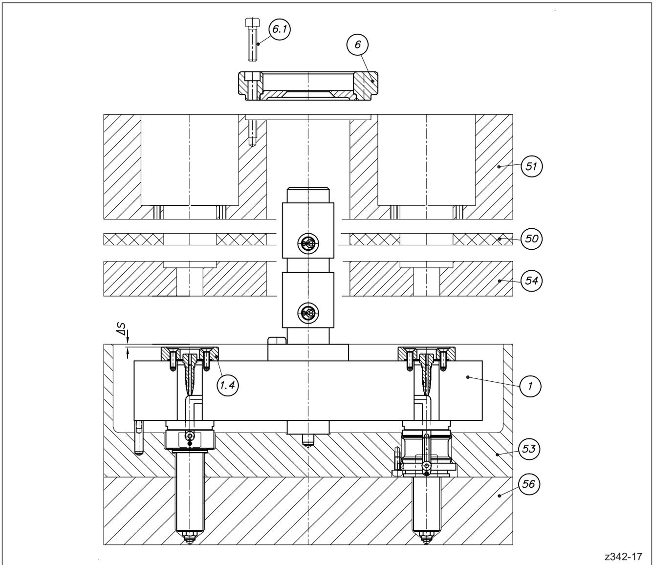
Abbildung 41: Überprüfung des Spaltmaßes  $\Delta S$  und anschließende Montageschritte
