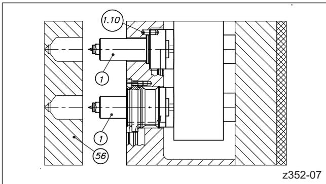
Abbildung 65: Konturplatte entfernen (HPS III-S Düse)
