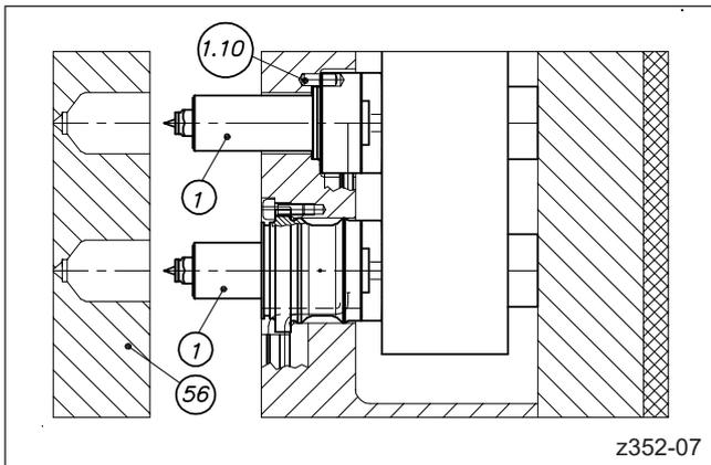
Abbildung 60: Konturplatte entfernen (HPS III-S Düse)
