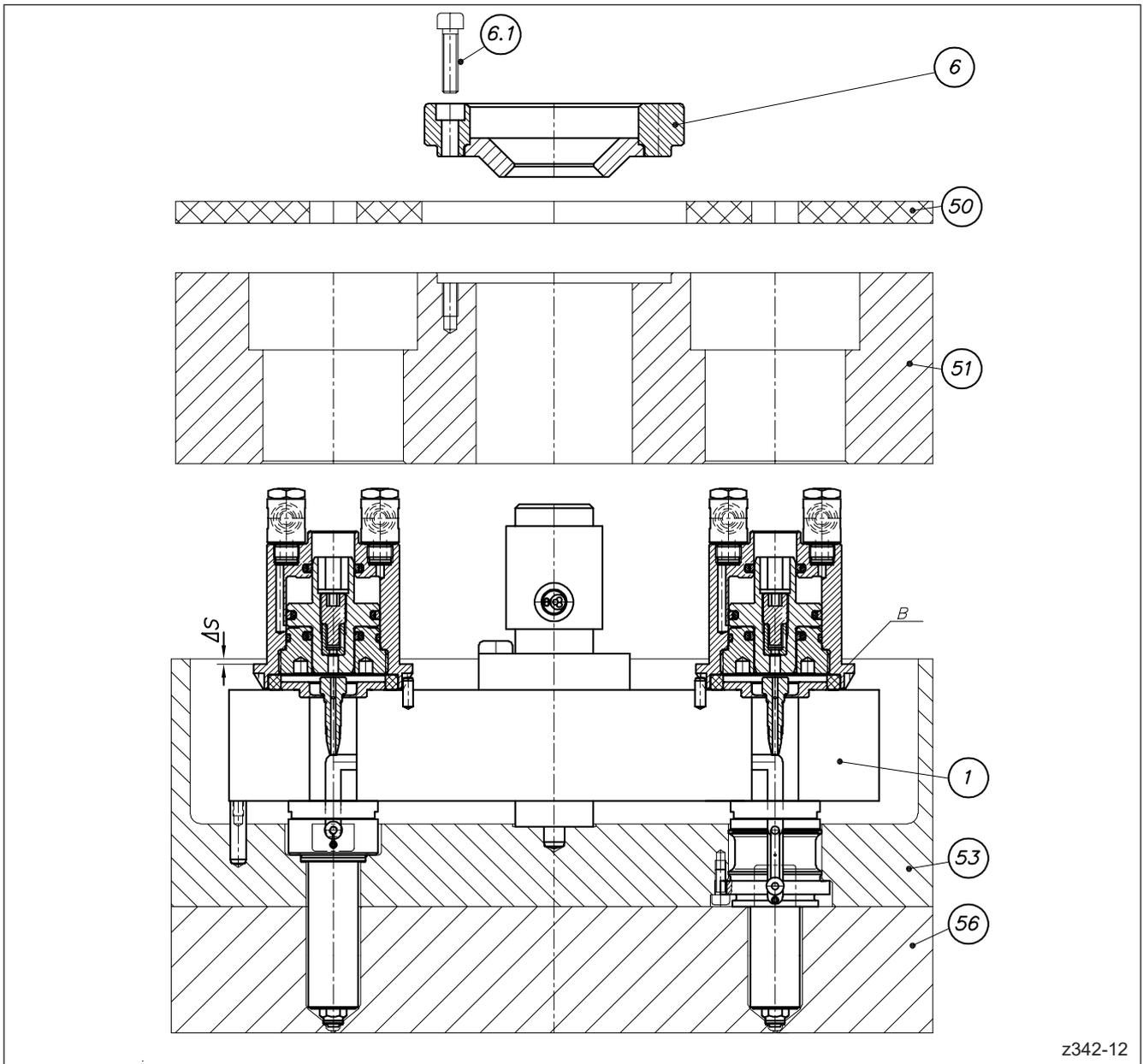
Abbildung 36: Überprüfung des Spaltmaßes  $\Delta S$  und anschließende Montageschritte
