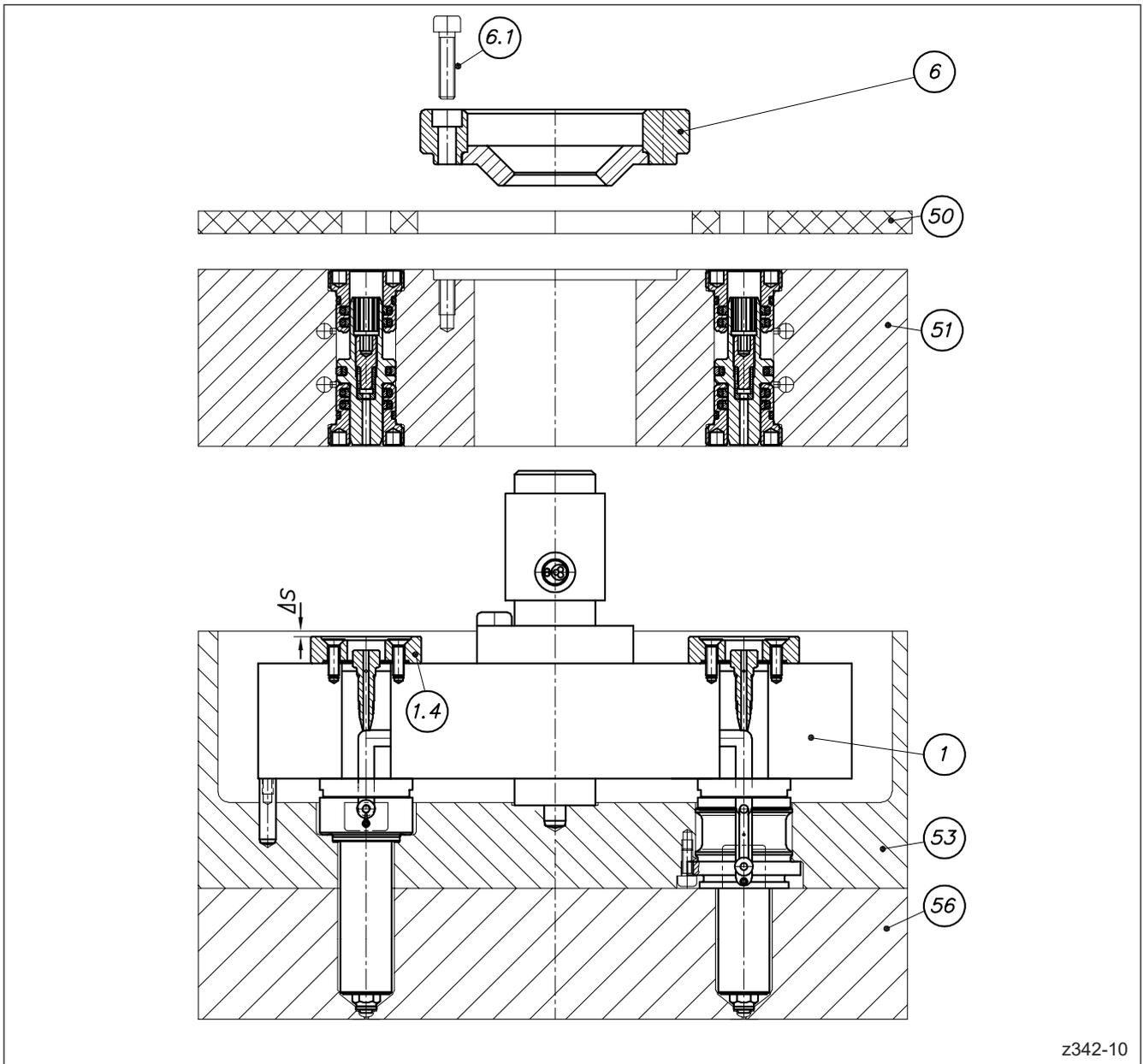
Abbildung 34: Überprüfung des Spaltmaßes  $\Delta S$  und anschließende Montageschritte
