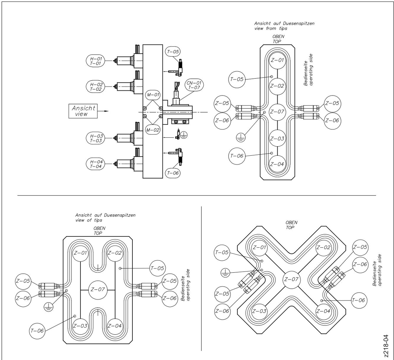
Abbildung 53: Verdrahtung von Standard-4-fach Heißkanalsystemen (Verteiler mit zwei Regelkreisen)
