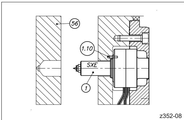
Abbildung 61: Konturplatte entfernen (HPS III-SXE Einzeldüse)
