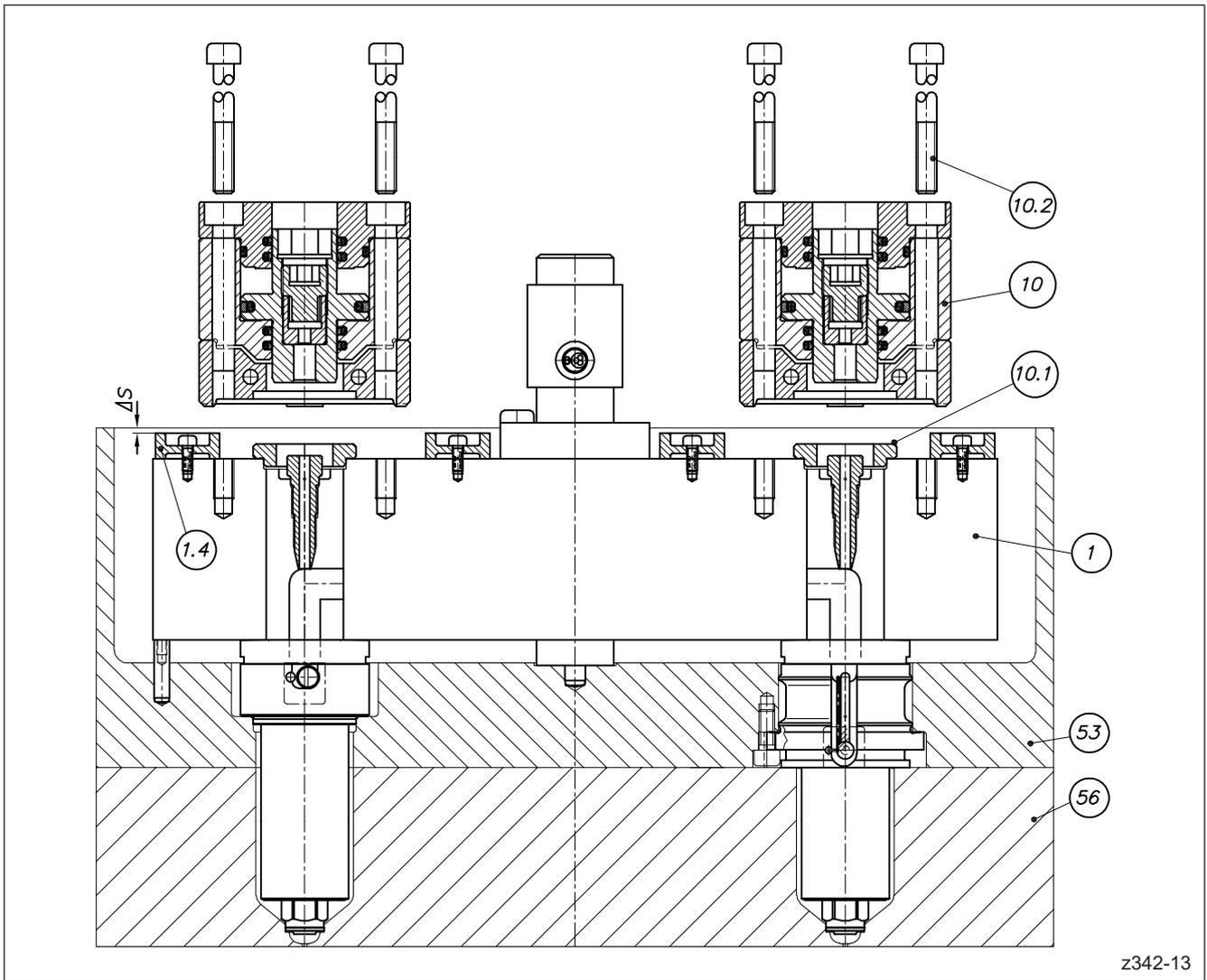
Abbildung 37: Überprüfung des Spaltmaßes  $\Delta S$  und Montage auf dem Verteiler
