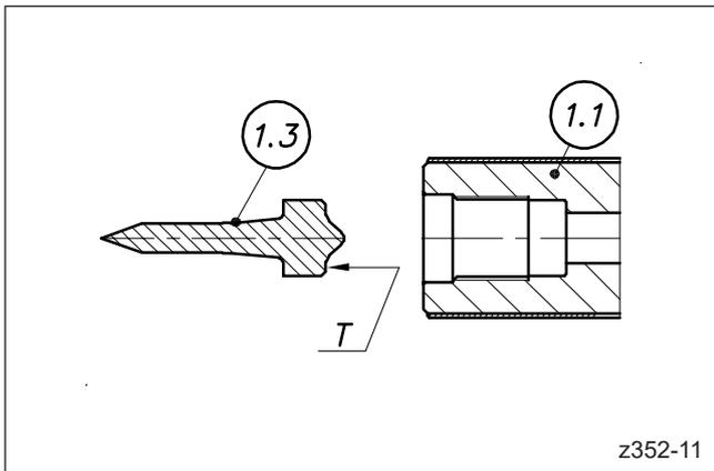
Abbildung 70: Düsenspitze montieren
