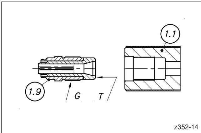
Abbildung 63: Düsenspitze montieren
