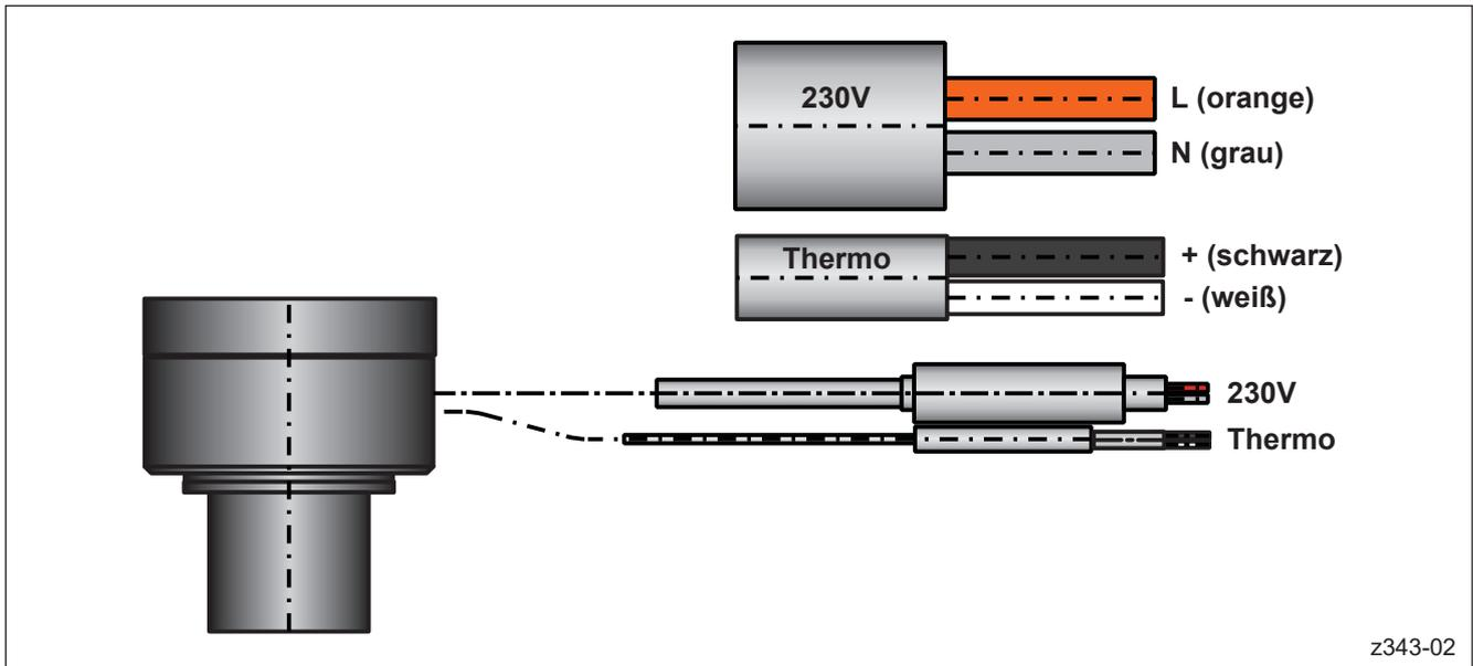
Abbildung 46: Kabelbelegung für HPS III-S Düsen (ein Regelkreis)
