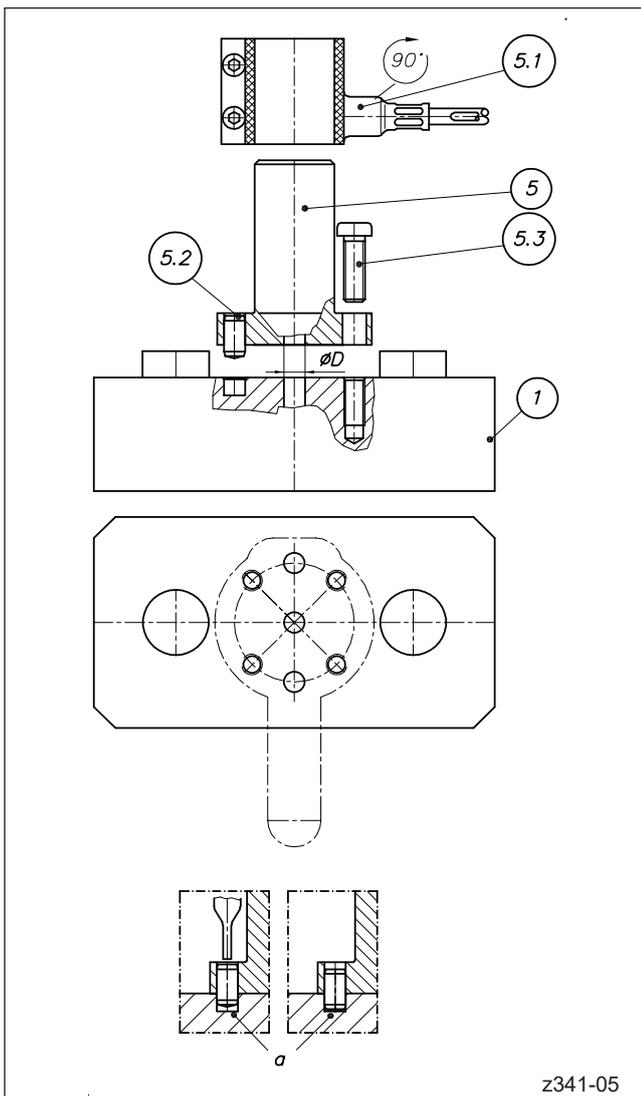
Abbildung 27: Einbau einer Angießbuchse
