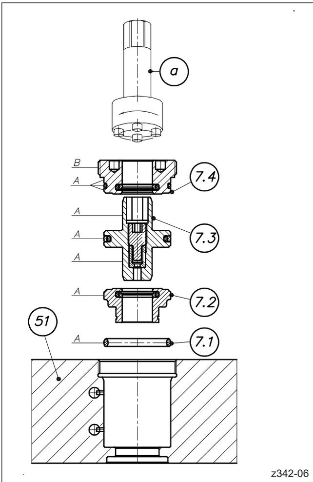
Abbildung 30: Montage eines integrierten Antriebs (Variante 1)
