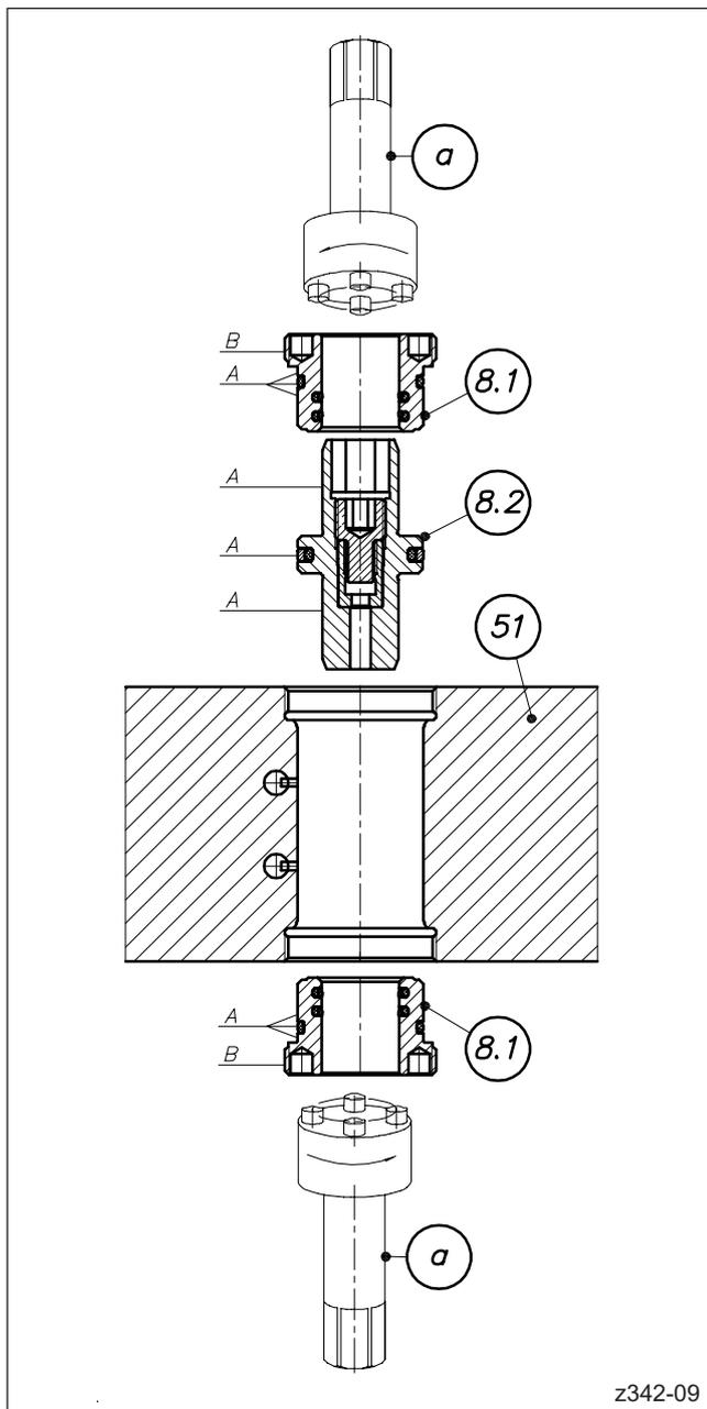
Abbildung 33: Montage eines integrierten Antriebs (Variante 2)
