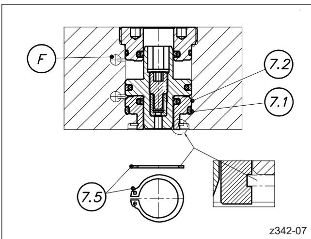
Abbildung 31: Montage des Sicherungsring
