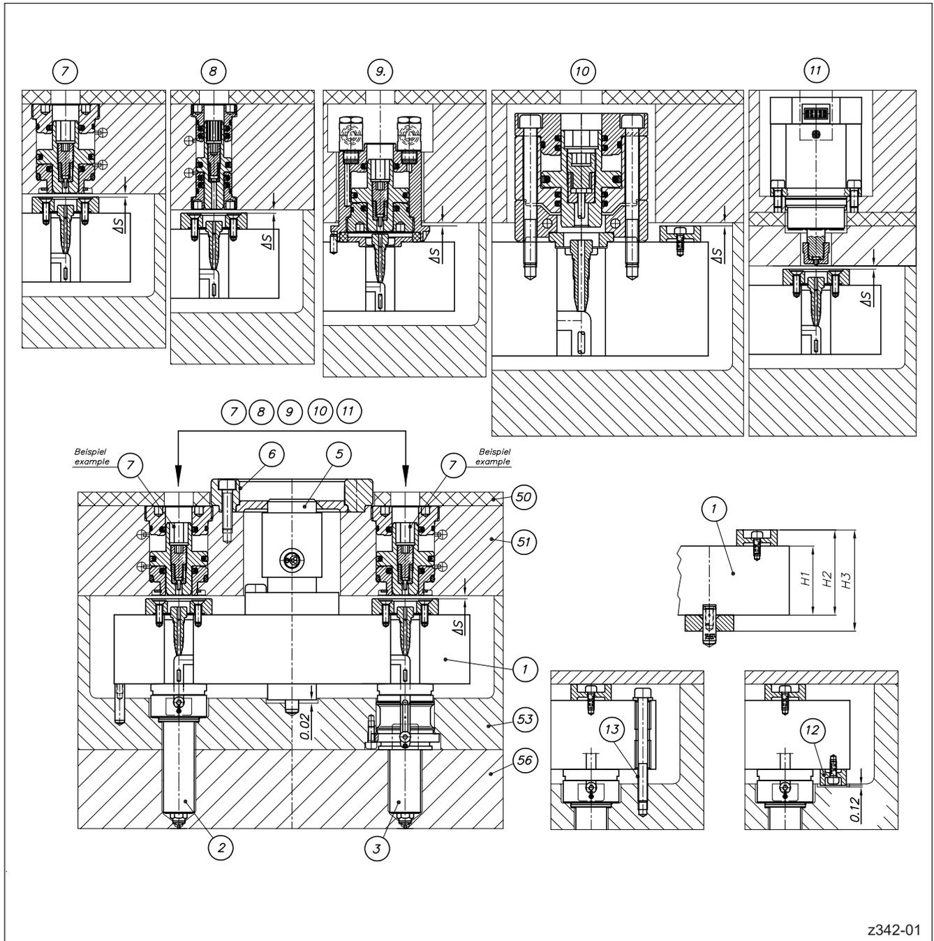
Abbildung 23: Prinzipieller Aufbau eines Nadelverschluss-Systems mit Einzelantrieben für HPS III-S Düsen für Standard- und Frontmontage
