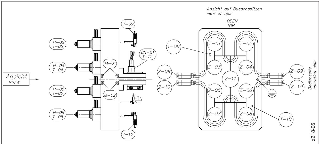
Abbildung 55: Verdrahtung von Standard-8-fach Heißkanalsystemen (Verteiler mit zwei Regelkreisen)
