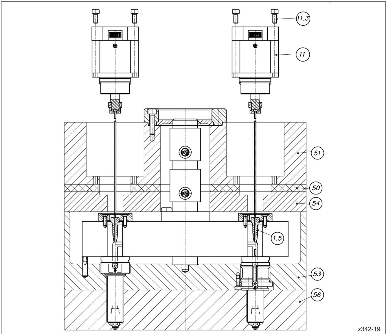
Abbildung 43: Montage eines elektrischen Antriebs in der Aufspannplatte
