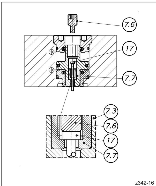
Abbildung 40: Einbau einer Verschlussnadel
