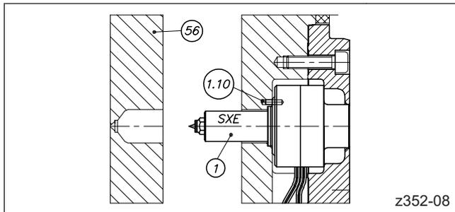
Abbildung 66: Konturplatte entfernen (HPS III-SXE Einzeldüse)
