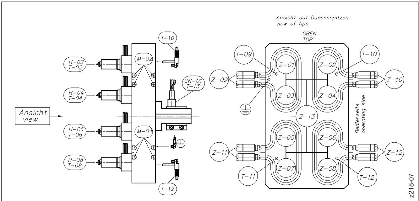
Abbildung 56: Verdrahtung von Standard-8-fach Heißkanalsystemen (Verteiler mit vier Regelkreisen)
