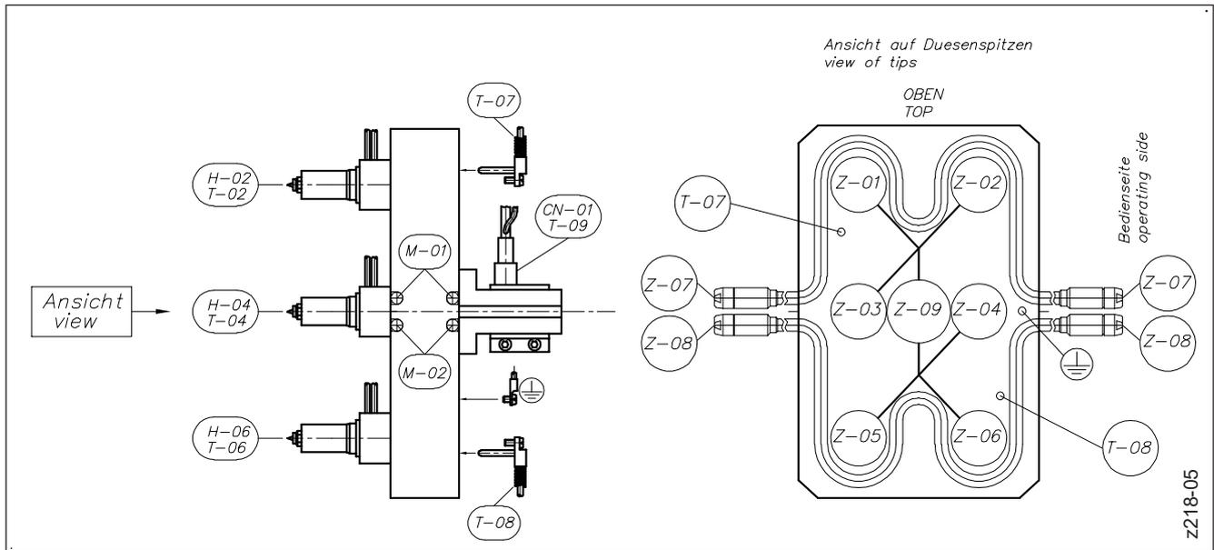
Abbildung 54: Verdrahtung von Standard-6-fach Heißkanalsystemen (Verteiler mit zwei Regelkreisen)
