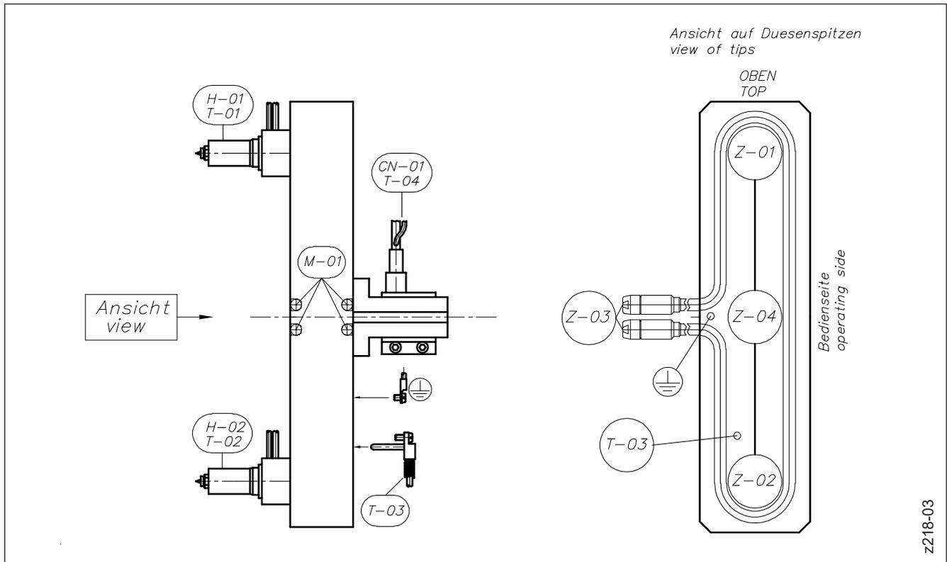
Abbildung 52: Verdrahtung von Standard-2-fach Heißkanalsystemen
