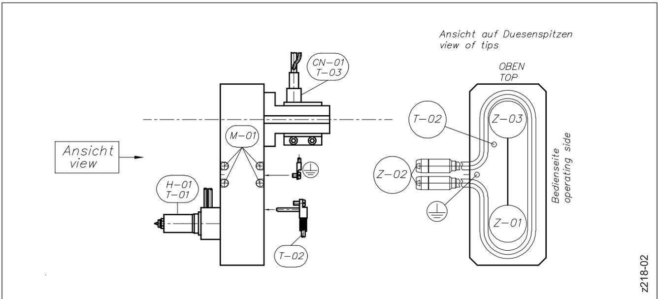
Abbildung 51: Verdrahtung von Standard-1-fach Heißkanalsystemen
