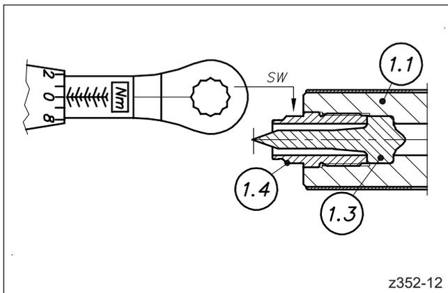
Abbildung 72: Düsen Spitze mit Drehmoment anziehen
