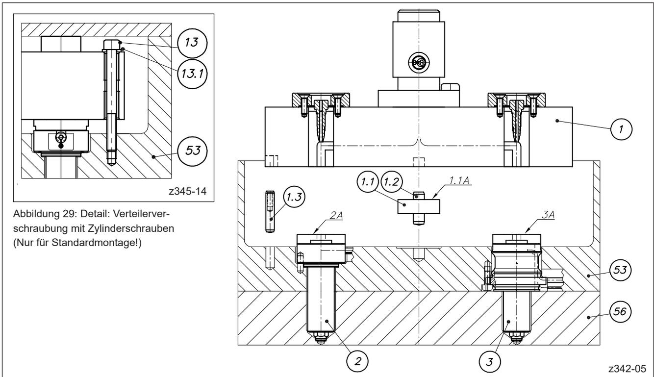
Abbildung 29: Detail: Verteilerver-schraubung mit Zylinderschrauben (Nur für Standardmontage!)
