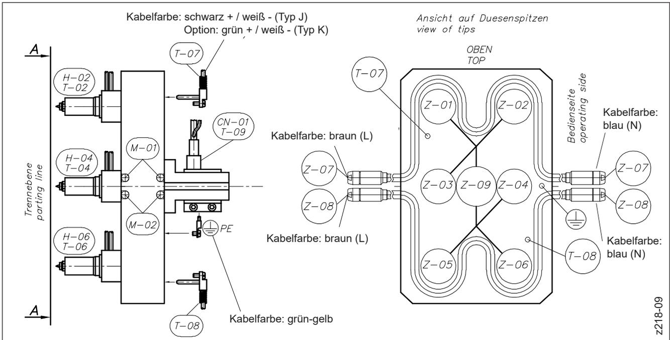
Abbildung 50: Verdrahtungsreihenfolge (Beispiel: 6-fach System)
