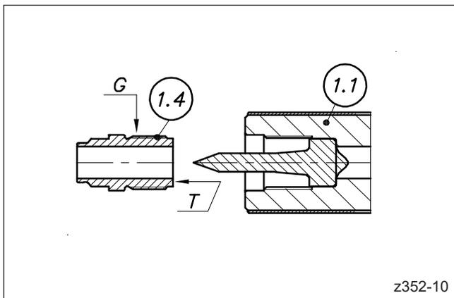
Abbildung 71: Düsen Spitze montiert
