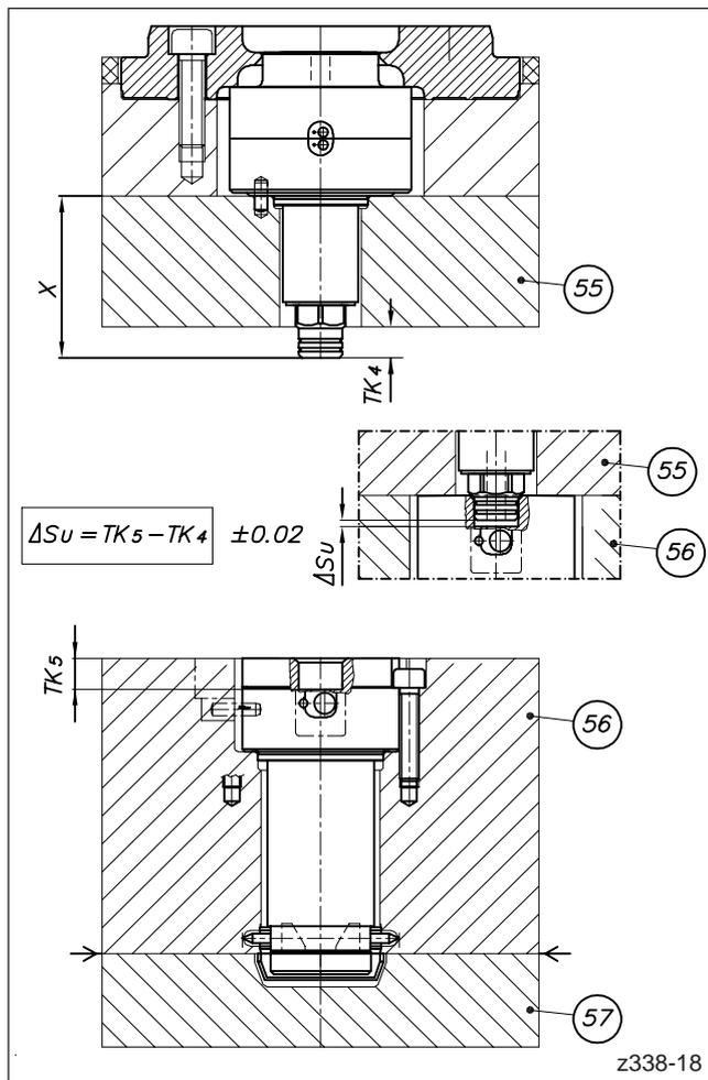
Abbildung 42: Kontrolle des Spaltmaßes  $\Delta S_U$
