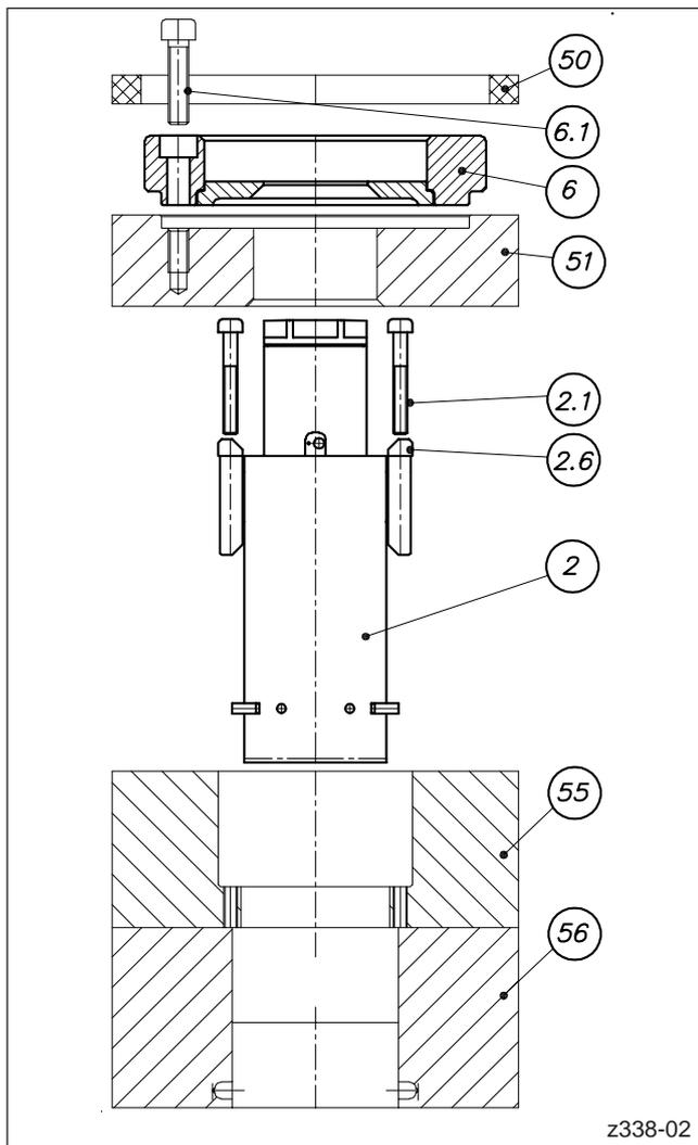
Abbildung 27: Montage des Düsenkörpers
