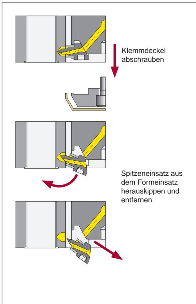
Abbildung 72: Spitzeneinsätze demontieren
