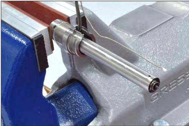
Abbildung 88: Benetzte Fühlerspitze
