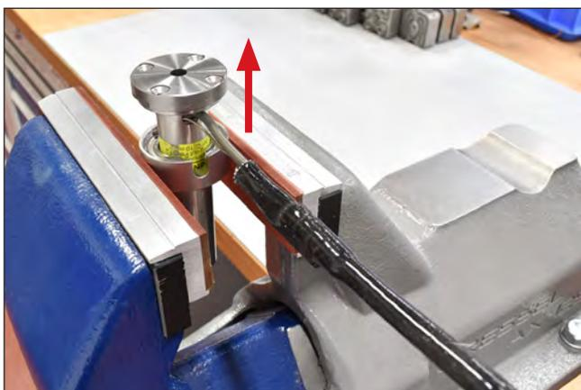
Abbildung 93: Druckrohr herausziehen
