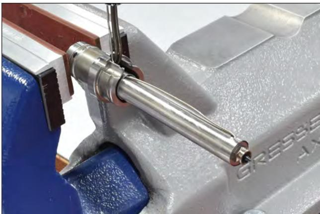
Abbildung 86: Schutzrohr verschieben
