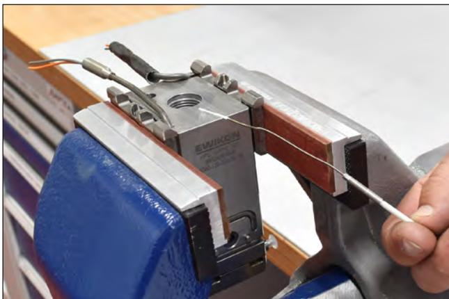
Abbildung 108: Benetzte Fühlerspitze
