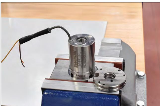
Abbildung 119: Haltering demontieren
