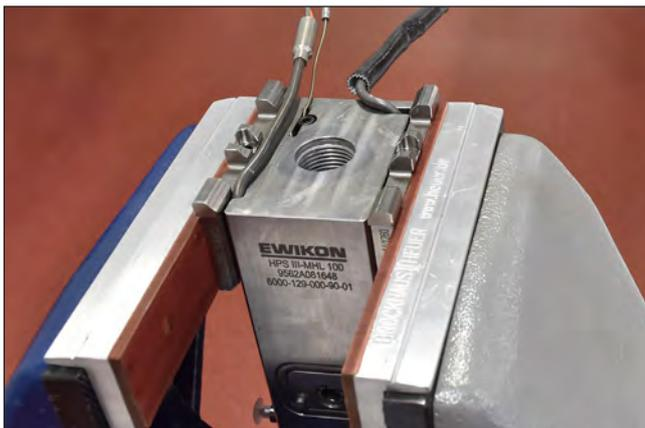
Abbildung 109: Thermofühler in die Bohrung stecken und fixieren
