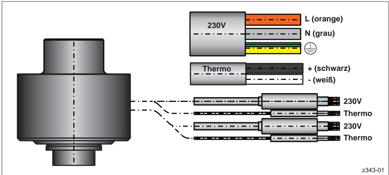
Abbildung 48: Kabelbelegung für HPS III-SXE Einzeldüsen (zwei Regelkreise)
