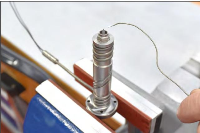
Abbildung 95: Benetzte Fühlerspitze
