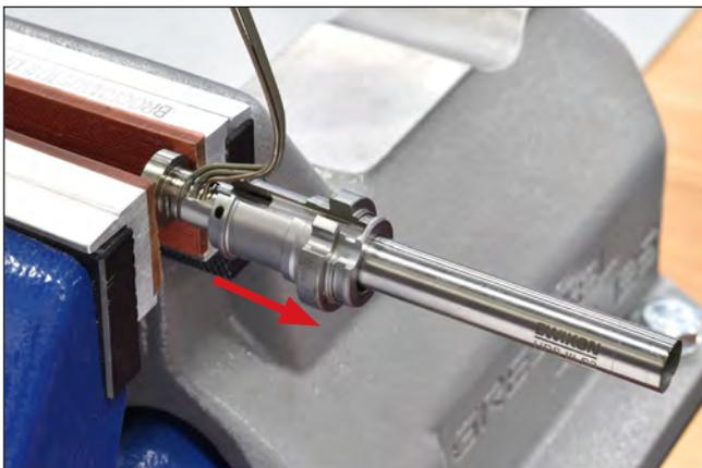
Abbildung 77: Düsenkörper abziehen
