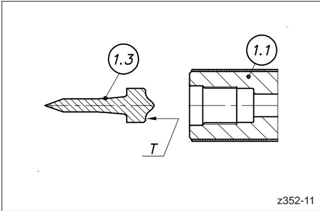
Abbildung 67: Düsenspitze montieren
