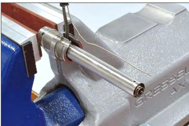
Abbildung 87: Defekten Thermofühler demontieren
