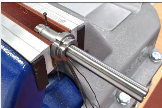
Abbildung 82: Vorzentrieren um die Spannhülsen zu montieren
