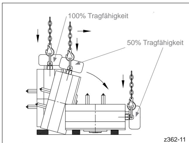
Abbildung 21: Bewegen von Heißkanalbaugruppen (Heißen Seiten, Werkzeugplatten oder Verteilern) von aufrechter (senkrechter) in liegende (waagerechte) Position.
