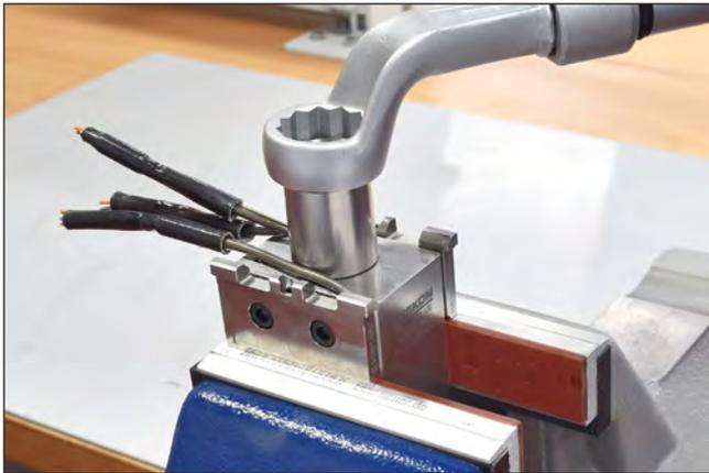
Abbildung 98: Düse einspannen und Adapter lösen
