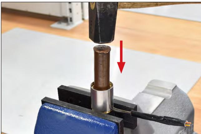
Abbildung 101: Schutzrohr demontieren
