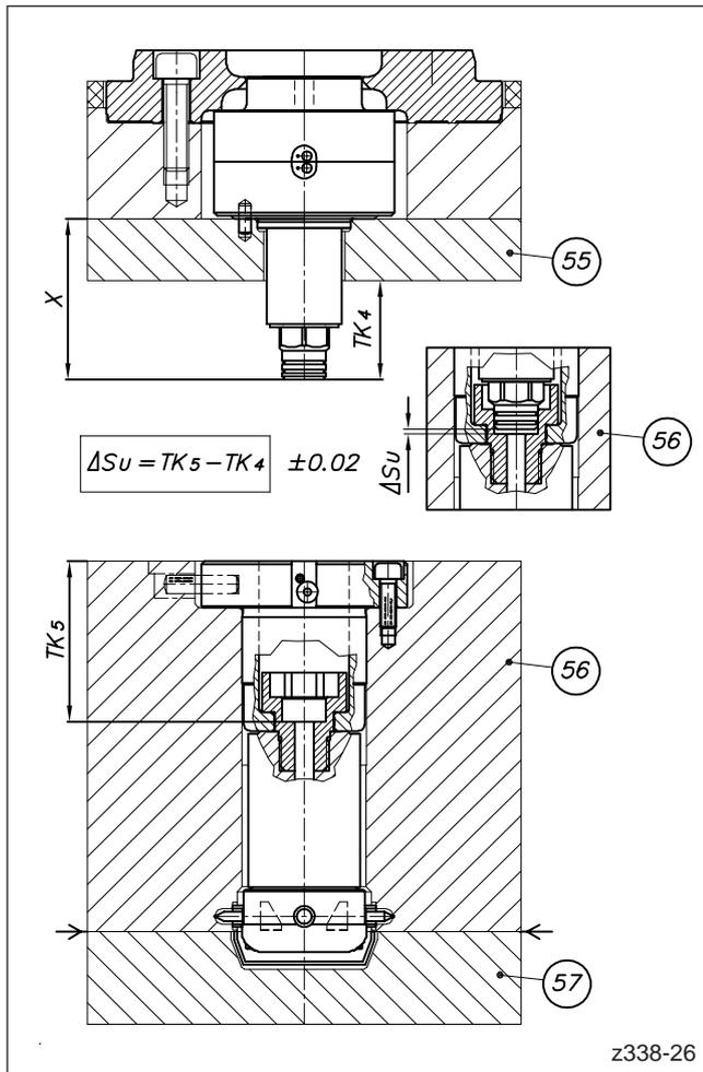
Abbildung 36: Kontrolle des Spaltmaßes  $\Delta S_u$
