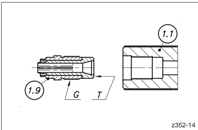
Abbildung 60: Düsenspitze montieren
