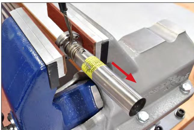
Abbildung 91: Schutzrohr demontieren
