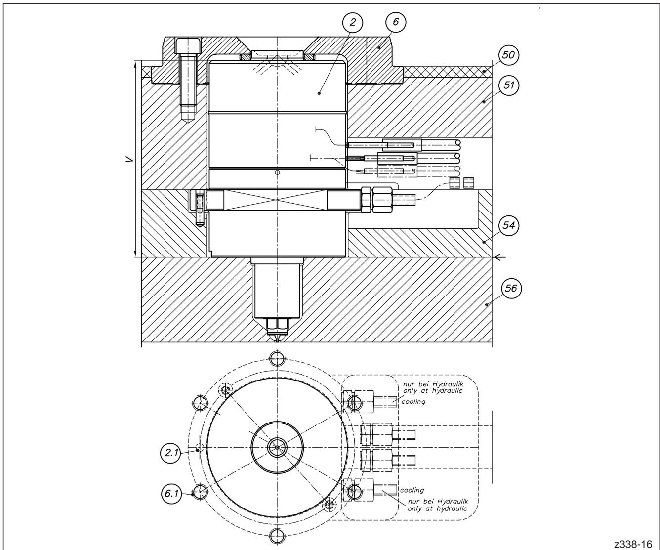
Abbildung 46: Prinzipieller Aufbau eines Systems mit HPS III-NVI Einzel-Nadelverschlussdüsen (Variante 2 - EN312 und EN218)
