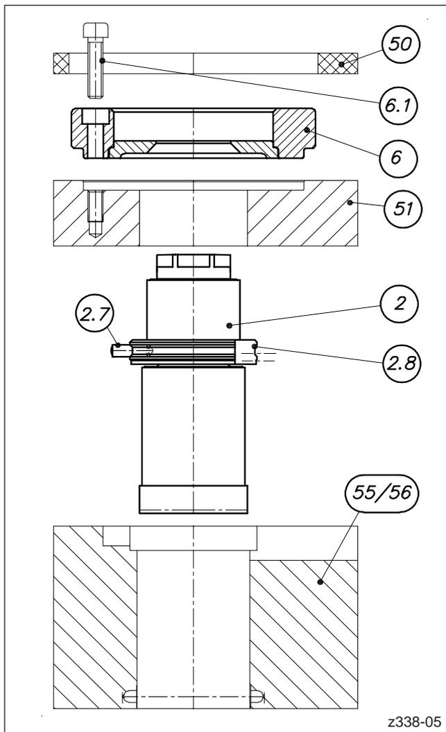
Abbildung 30: Montage des Düsenkörpers
