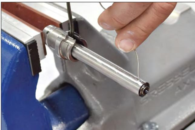
Abbildung 89: Thermofühler in die Bohrung der Düse stecken
