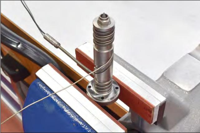
Abbildung 94: Thermofühler demontieren
