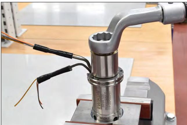
Abbildung 118: Düse einspannen, Adapter demontieren
