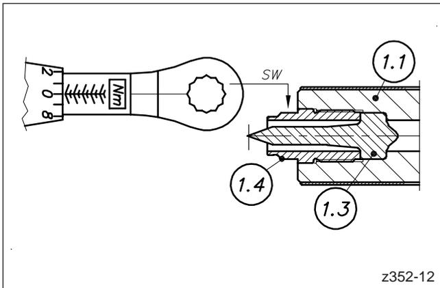
Abbildung 69: Düsen Spitze mit Drehmoment anziehen
