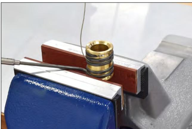
Abbildung 104: Thermofühler aufwickeln
