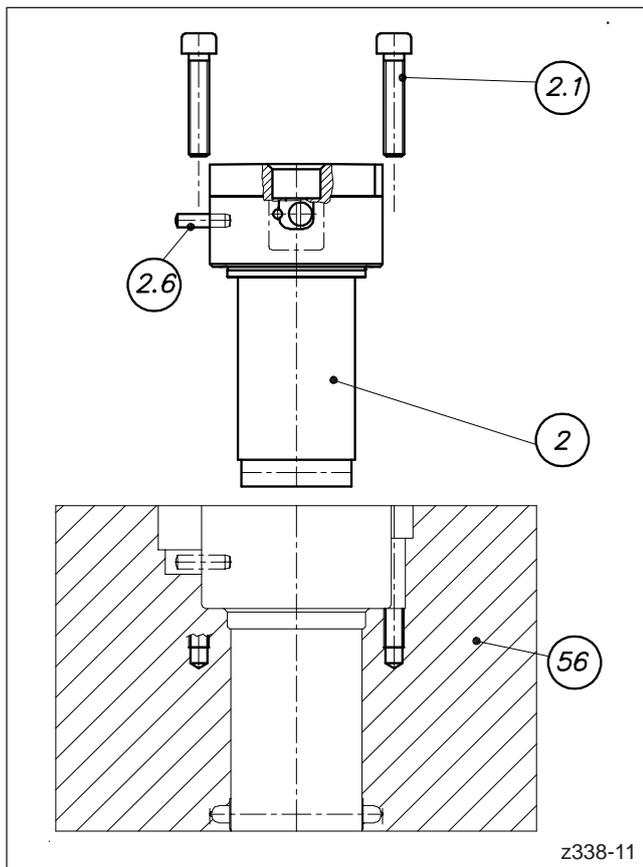
Abbildung 40: Montage des Düsenkörpers
