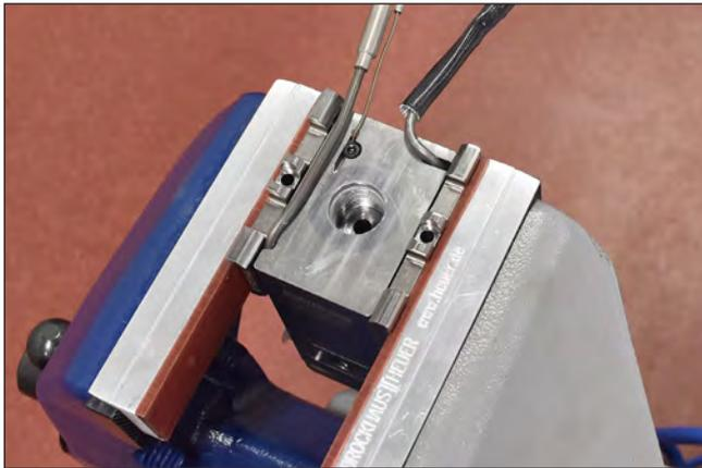
Abbildung 106: Düse einspannen, Schraube lösen
