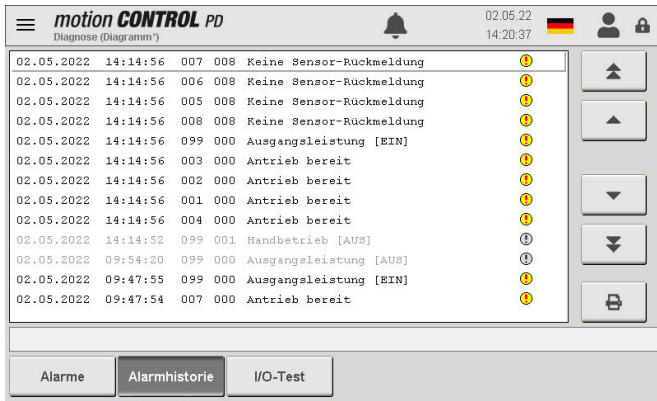
Abbildung 18: Ansicht „Diagnose und Fehlersuche – Alarmhistorie“
